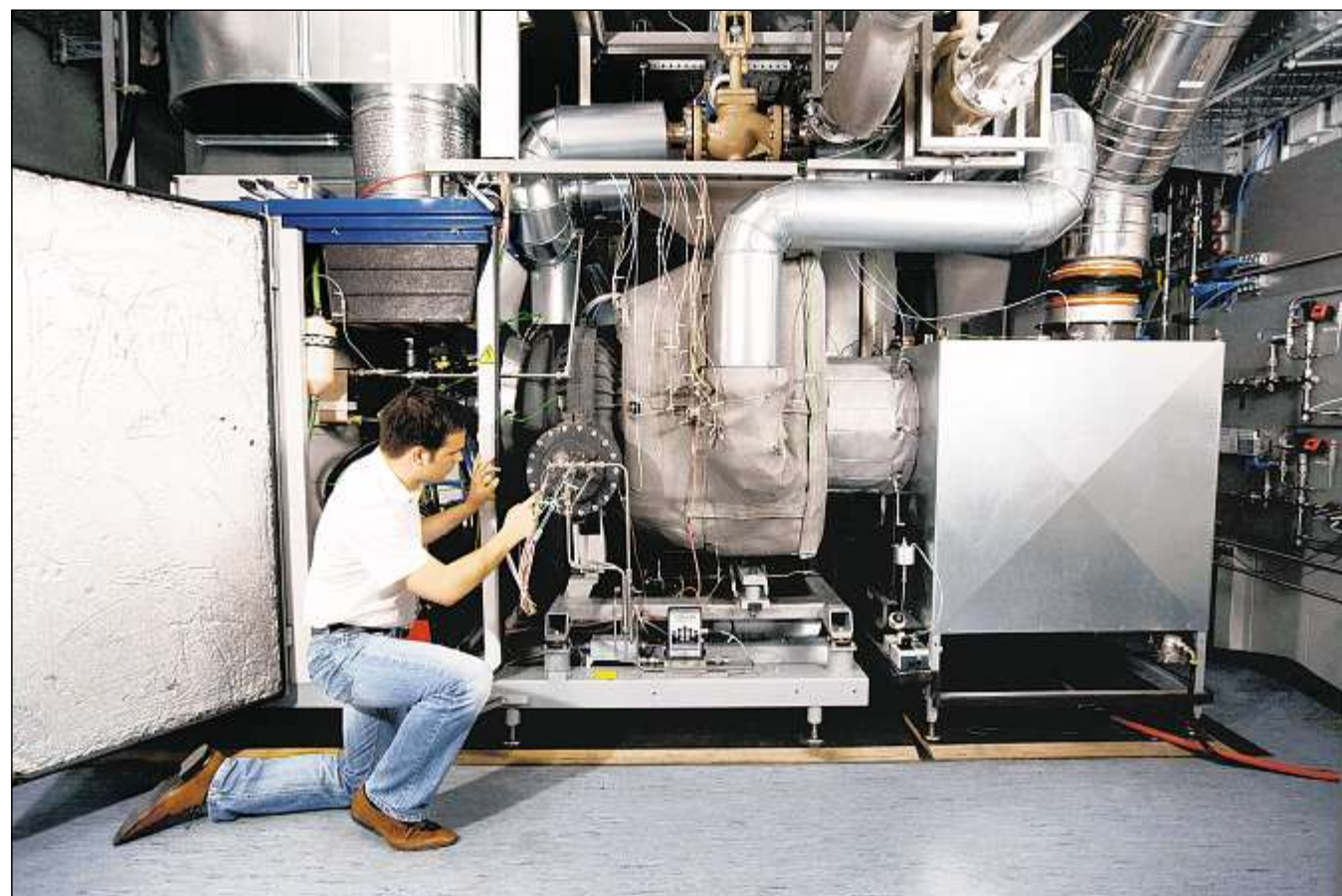
MAKRO FÜR MIKRO: Auf diesem großen Teststand werden die Prozessabläufe in einer Mikro-Gasturbine optimiert. Wesentlich kleinere Versionen dieser Vielstoff-Verbrennungsmaschinen könnten künftig Eigenheime mit Strom und Wärme versorgen. Foto: DLR
