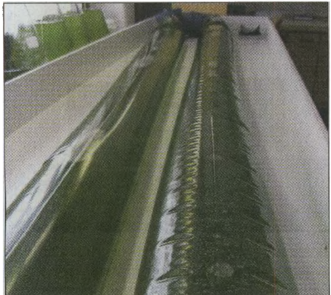
Fotobioreaktor iz plastičnih cevi, v katerem Marjeta Resnik vzgaja in proučuje mikroalge.
